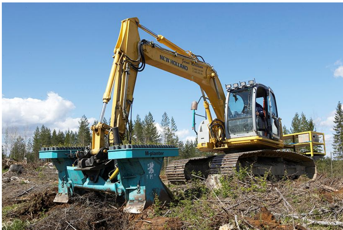
Рисунок 15 – Bracke M-planter на базе экскаватора
