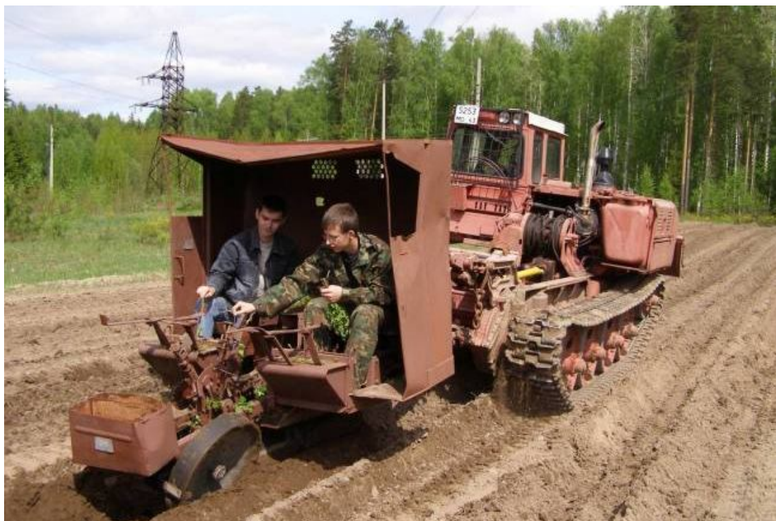
Рисунок 13 – Работа сажальщиков на лесопосадочной машине МЛУ-1
